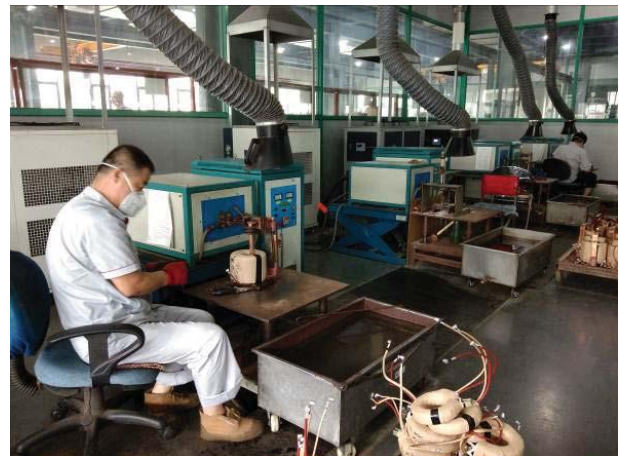
工位抽风装置
