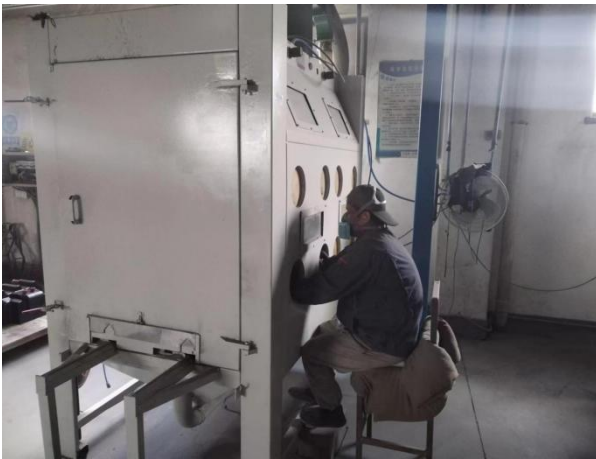
高噪声设备使用护罩降噪-喷砂机
